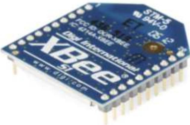
Fig. 2.4. XBee S1 Module.
